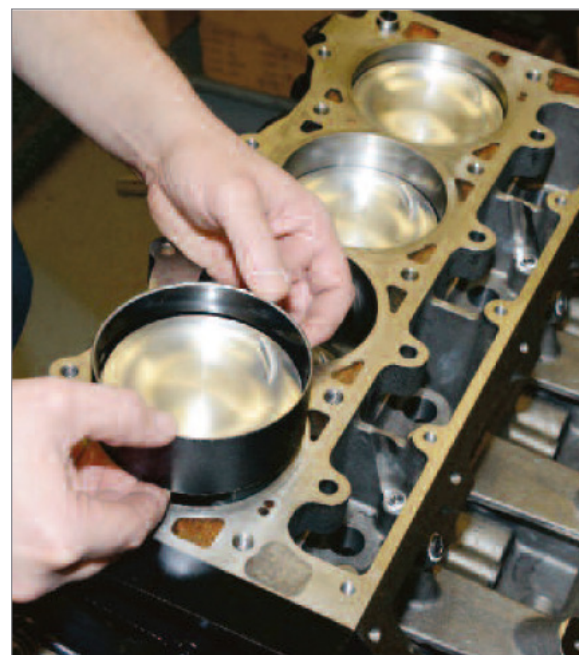
Przyrząd ściskający pierścienie tłokowe ułatwiający prawidłowy montaż tłoka w cylindrze.
