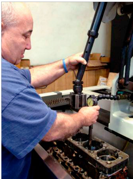
Pomiar średnicy cylindra i odchytek błędów kształtu przy pomocy średnicówki z czujnikiem zegarowym z działką elementarną 0,002mm
