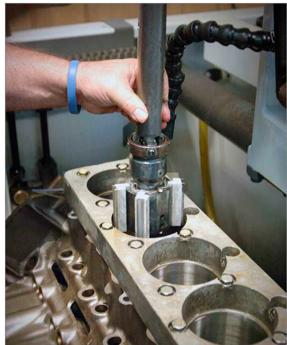
Głowica honująca Sunnen DH z osetkami diamentowymi zapewnia wielopunktowy kontakt osetek z otworem. System rozsuwania osetek z podwójnym stożkiem zapewnia jednolity docisk osetek do ściany cylindra co skutkuje wyjątkową jego okrągłością. Żywotność zestawu osetek honujących wyniosła w firmie White Performance 18 miesięcy.
